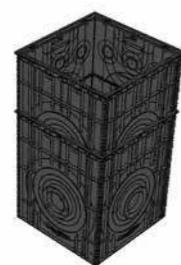
При необходимости изделие можно использовать в качестве секции колодца. Для наращивания можно использовать как полную высоту колодца (600мм), так и половину (300мм). В третьем варианте требуется дополнительно подрезать верхнюю часть по шаблонам (подрезать выступающие ребра и отводы)
