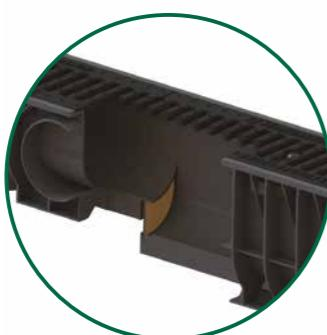
Пластиковые переходники предназначены длястыковки лотков серии PolyMax, имеющих одинаковую ширину сечения (например, DN 100), но различную высоту (h80, h120). Переходник устанавливается в пазы канала, что позволяет формировать каскад линии лотков, обеспечивая отвод сточных вод при нулевом уклоне поверхности.
