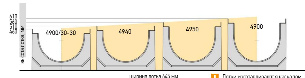
! Лотки изготавливаются каскадом с шагом 5 мм по высоте
