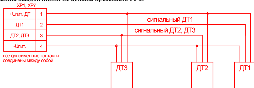
Рис.7-2. Подключение электронных термопреобразователей.
